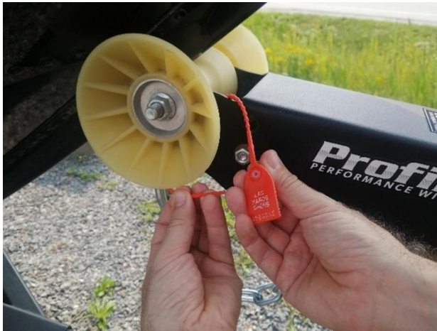
Figure 7 : Exemple d'installation de sceau sur la remorque à travers l'œillet de l'embarcation
