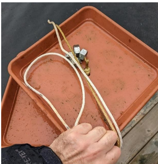
Figure 10 : Substrat de type artisanal et ses poids
