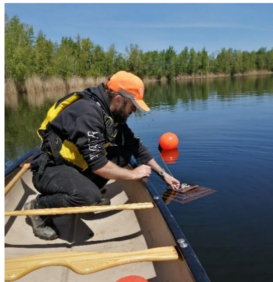
Figure 8 : Mise à l'eau d'un substrat de type scientifique
