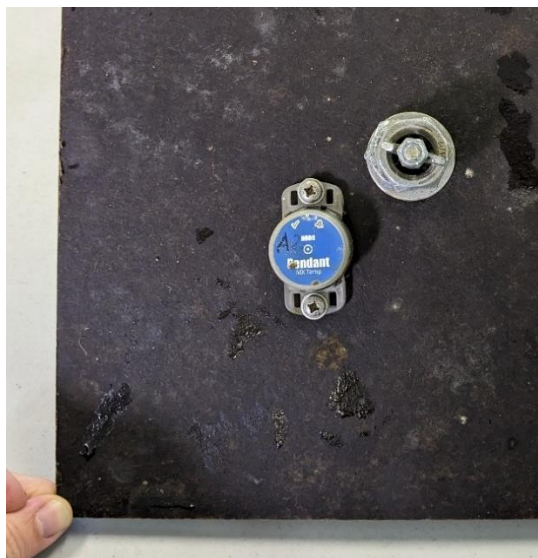
Figure 11 : Enregistreur de température placé sous le substrat de type scientifique
