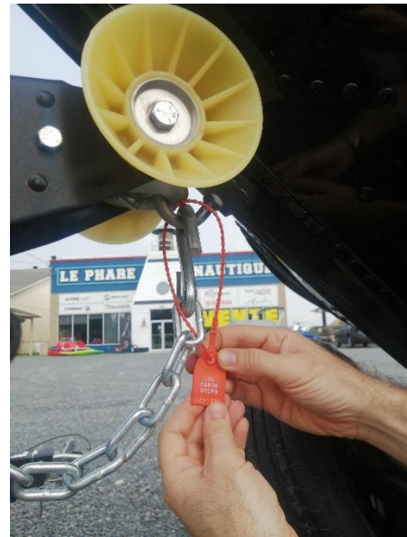
Figure 6 : Exemple d'installation de sceau sur la chaîne de la remorque
